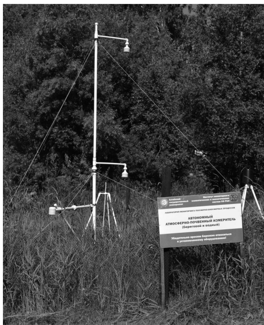
Рис. 2. Автоматический атмосферно-почвенный измерительный комплекс
