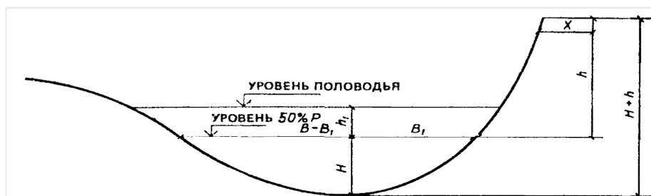
Рис. 2. Схема поперечного профиля русла с указанием параметров, входящих в формулу (1)
