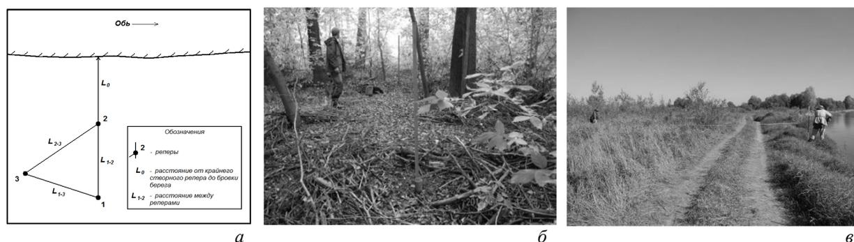
Рис. 4. Иллюстрации к методике наблюдений за отступанием бровки берега: а – схема опорного створа № 2; б – вешки на основных реперах створа № 4-а, вид в сторону реки; в – измерение расстояния от базового репера до бровки берега на створе № 3.
