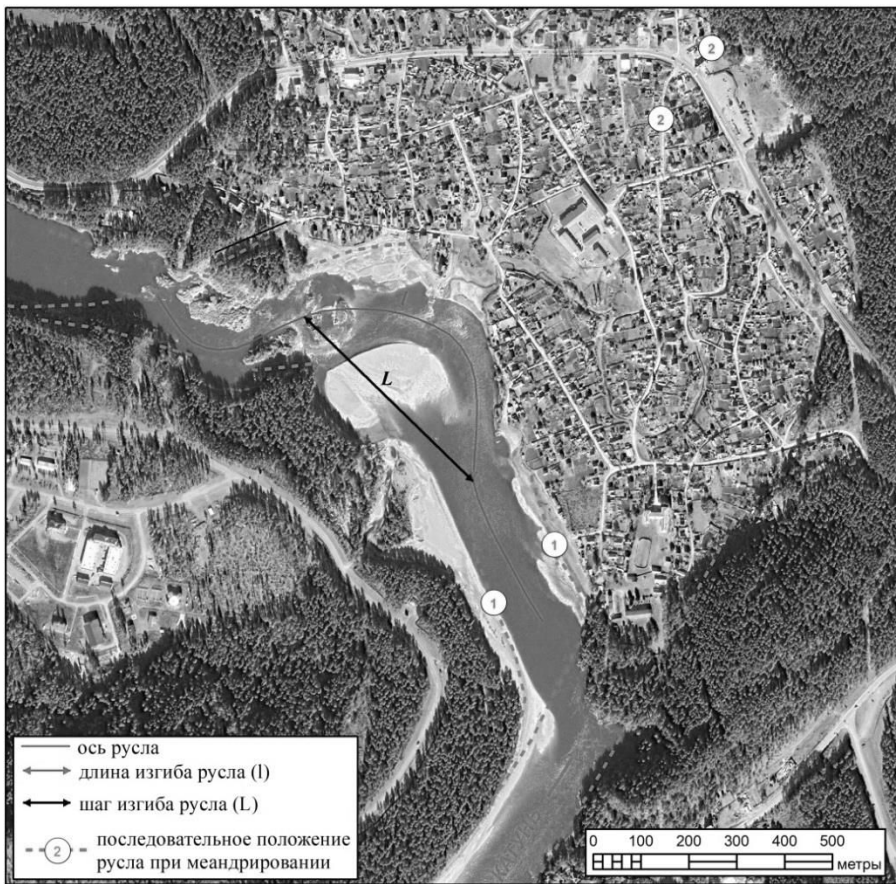
Рис. 8. Геометрические параметры русла р. Катунь на территории с. Манжерок и общая направленность возможного процесса меандрирования русла
