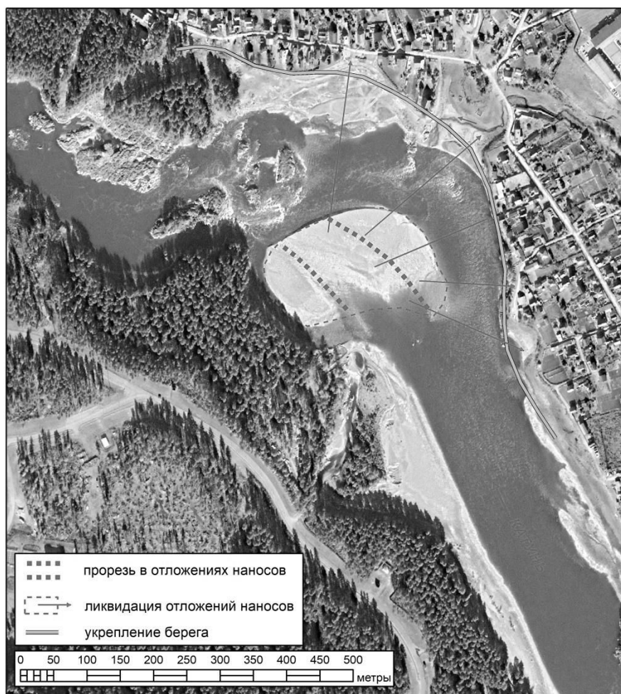
Рис. 10. Схема мероприятий по противодействию негативному ходу руслового процесса на территории с. Манжерок
