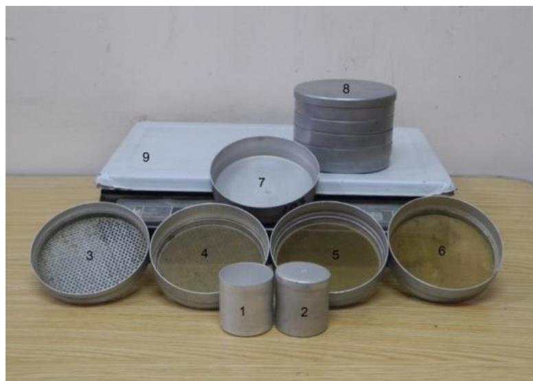
Рис. 3. Оборудование для гранулометрического анализа проб русловых наносов:
