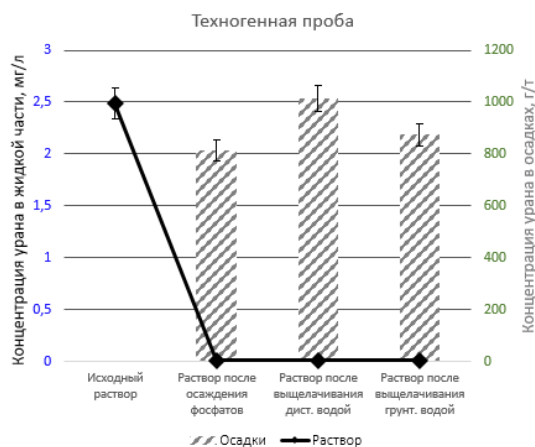
Рис. 3. График изменения фазового состояния урана в техногенной пробе в осадке и растворе Fig. 3. Graph of the phase state change of uranium in the technogenic sample in the sediment and solution
