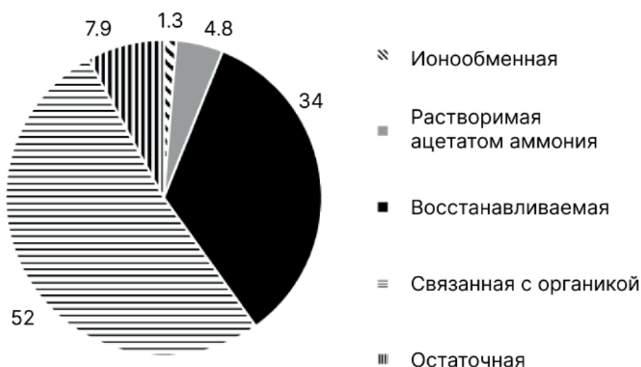
Рис. 4. Распределение урана по фракциям в грунтовых пробах, %
